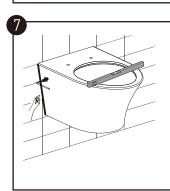
将坐便器后端安装孔对准墙上的定位柱后插入,然后用內六 角扳手将紧固螺钉拧进两侧安装孔。调节坐便器水平并锁紧 螺钉,并在与墙接触的边沿涂抹中性防霉硅胶以填平接触面 的缝隙。
