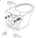
将塑料紧固件从坐便器内侧插入安装孔,塑料垫片和六角螺 帽从外侧依次套入紧固件螺纹轴,然后拧紧。
