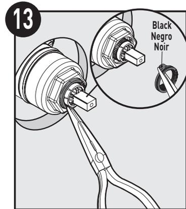
Remove the adjustable temperature limit stop. Retire el tope de límite de temperatura ajustable. Enlever le limiteur de température réglable.
